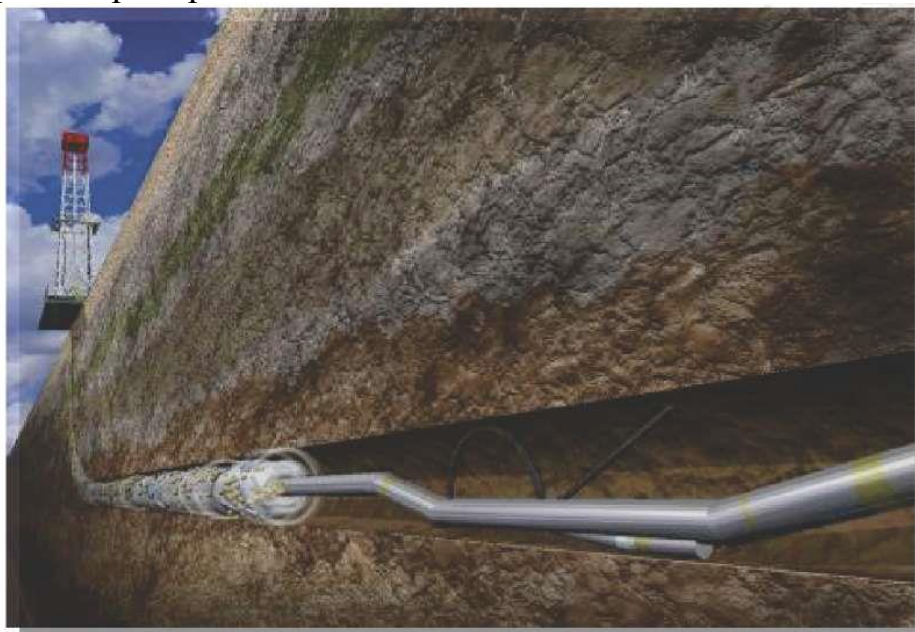
Рисунок 10 — Положение каротажного прибора в горизонтальных скважинах
